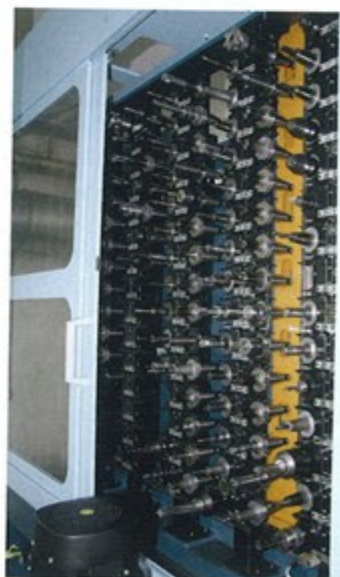
Mit 240 Werkzeugen reicht der Speicher für (fast) alle Bearbeitungen.
