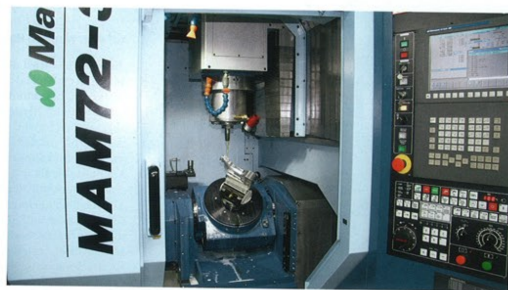
Features wie beispielsweise eine direkte Wegmessung für B- und C-Achse und den Linearachsen X/Y/Z gehören bei der MAM72-3VS zur Standardausstattung.
