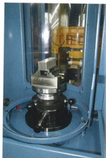
Der gut zugängliche Rüstplatz erleichtert die Aufspannen der Teile.
