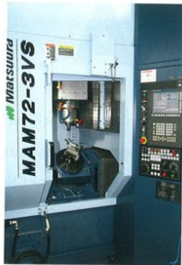
Allein die Gusskonstruktion wiegt mehr als 6 Tonnen.
